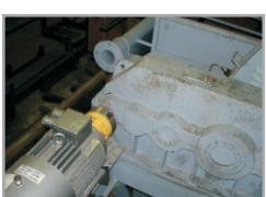
10. Приводы вращения мешалки и вала с секторами имеют широкий ассортимент по комплектации. Вращение может быть с постоянной скоростью или регулироваться частотным преобразователем. Соединение электродвигателя и редуктора осуществляется через втулочно-пальцевые или лепестковые муфты.
