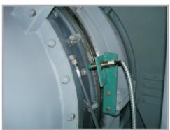
6. Включение отдувки выполняется с помощью сенсорных датчиков. При отдувке кека с секторами каждого коллектора, осуществляется один или несколько импульсов. Продолжительность отдувки, задержка отдувки и частота импульсов задаётся контроллером.
