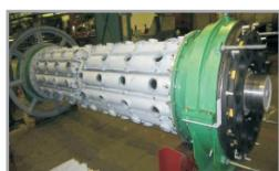
**1.** Вместо литого чугунного вала используется набор из 24 легкосъемных трубчатых коллекторов, закрепленных на центральной несущей трубе из двух секций. Для увеличения эффективности работы фильтра коллекторы смонтированы со смещением на 15 градусов относительно друг друга. Сечение каналов и горловины секторов увеличены на 70 % по сравнению с фильтрами ДШ, что повышает качество сушки и производительность.
