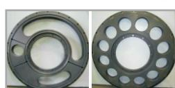
**3.** Между распределительными головками и цапфами находятся распределительные и ячейковые шайбы из износостойкого капролона. При этом срок службы шайб увеличивается в несколько раз в отличие от чугунных.
