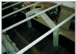
9. Устройство промывки фильтрткани на секторах позволяет очистить фильтрткань от остатков концентратов, частично регенерируя ее фильтровальную способность и замедляя падение производительности.
