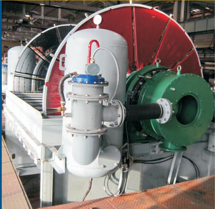
Предназначен для нейтральных, щелочных и слабо агрессивных суспензий (РН 4-11) с частицами твердой фазы однородной крупности при температуре от 2°С до 60°С.
