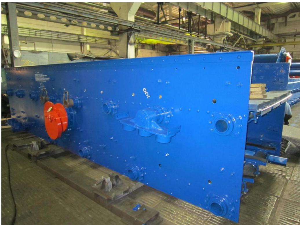
Грохот инерционный ГИТ62Е предназначен для отсева сыпучих материалов с объемной массой насыпного груза не более 2,8 т/м<sup>3</sup> и применяется на предприятиях черной и цветной металлургии, а также строительной промышленности в качестве технологического оборудования.
