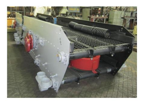
Грохот инерционный ГИТ42А предназначен для мокрого грохочения руд, отмывки, а также дренажа суспензий и отмывки утяжелителя.
