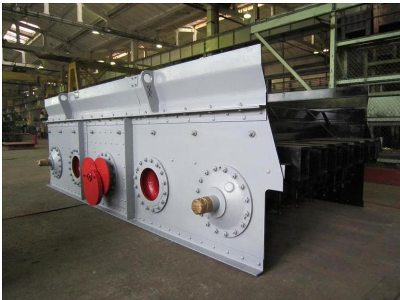
Грохот инерционный ГИТ71М предназначен для отсева руды, сланцев, угля на два класса по крупности.
