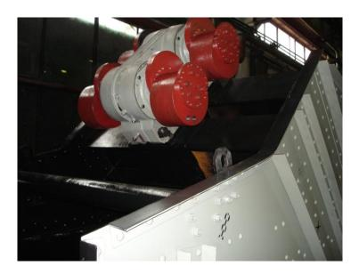
Грохот инерционный ГИСЛ82АК предназначен для грохочения сыпучих материалов с объемной массой насыпного груза до 1,4 т/м3 на операциях обезвоживания, обесшламливания, мокрого и сухого грохочения каменных углей, антрацитов и горючих сланцев, а так же для отмыва суспензии от продуктов их обогащения
